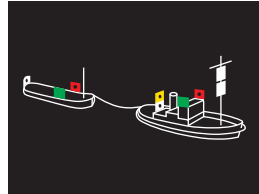
Schleppverbände in Fahrt; Links: bis 200 m Schleplänge (Schlepper nicht über 50 m Länge); Mitte: mit längsseits geschleppten Anhängen; Rechts: über 200 m Länge, mit außergewöhnlichem Schwimmkörper (schleppendes Fahrzeug über 50 m lang)
